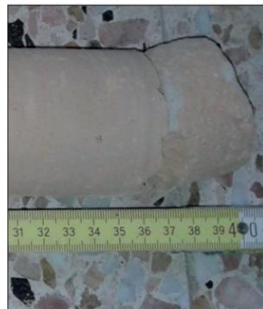
Fig. 2. Carotatura su muratura – viste carota estratta
