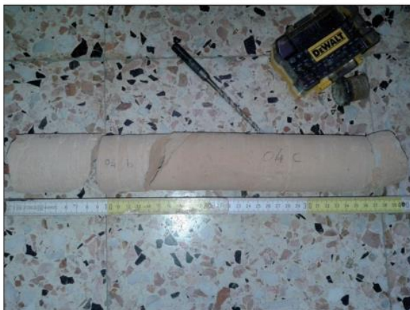
Fig. 2. Carotatura su muratura – viste carota estratta
